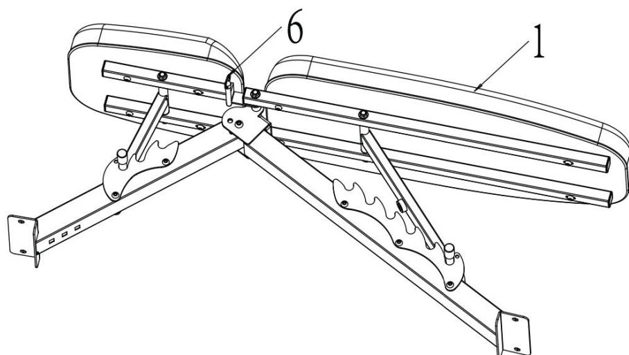
1. Разложите основную раму (1) в направлении, указанном стрелкой на рисунке, до соответствующего положения, а затем вставьте болт (6) в основную раму (1) для того, чтобы зафиксировать раму.
