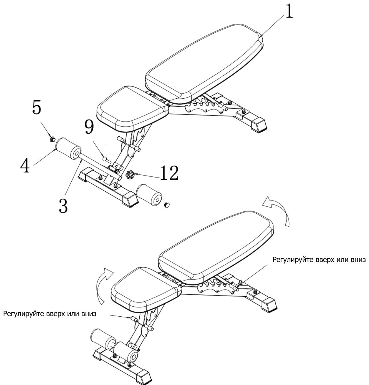
1. Вставьте винт (9) в регулировочную стойку (3) основной рамы (1) и затем закрепите детали с помощью регулировочной ручки. Установите неопрен (4) на опору для ног, а затем вставьте заглушку (5), чтобы закрепить детали.
